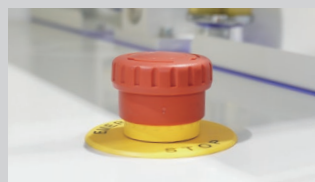
緊急時に押すことで緊急停止します。
