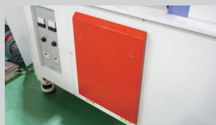
緊急時に膝等で試験機前面の停止板に衝撃を与えると緊急停止します。
