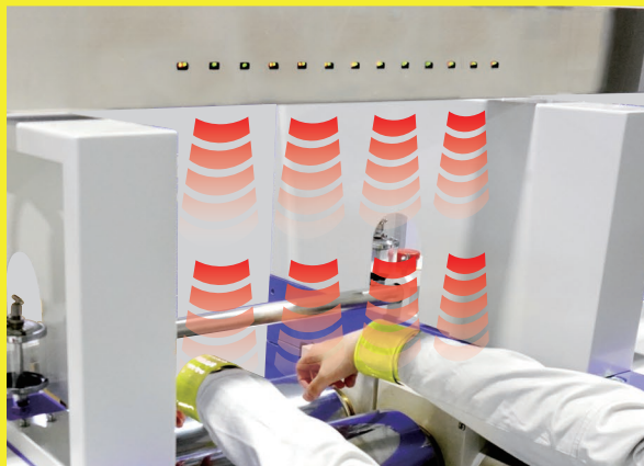
反射板検知式ブレーキ装置 No.191-TM / WM テストミキシングロール オプション機能
