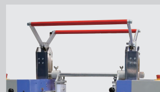
緊急時に試験機前面のバーに手や頭等で衝撃を加えると緊急停止します。
