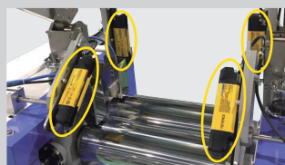
作業中に対になっているセンサー間に手等の異物が入るとロールを緊急停止します。
