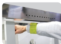
センサーに沿って手首を移動させ、正常に反応することを確認します。この作業後にロールを起動することができます。
